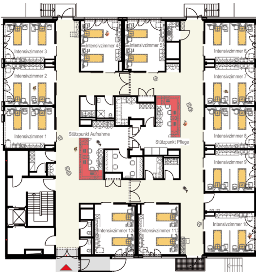
Grundriss der neuen Intensivstation
